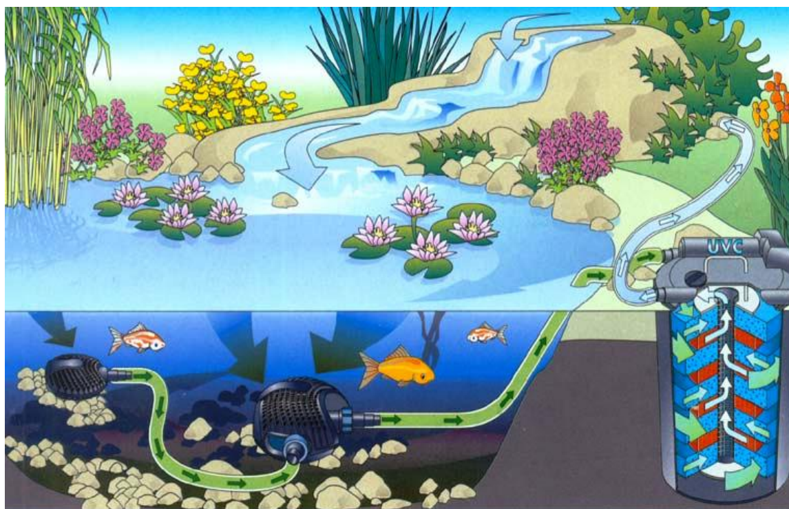
Obr.: Schéma záhradného jazierka so zdrojom dažďovej vody podľa spoločnosti Biogardens 29
